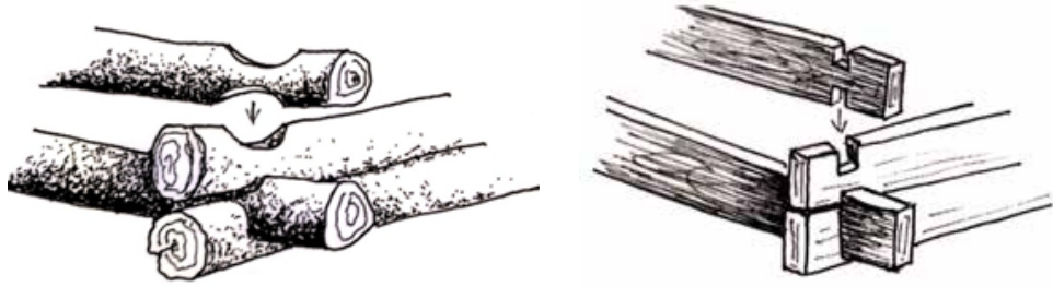
Şekil 1, 2: Karaboğaz ve kurtboğazı geçme teknikleri 7
